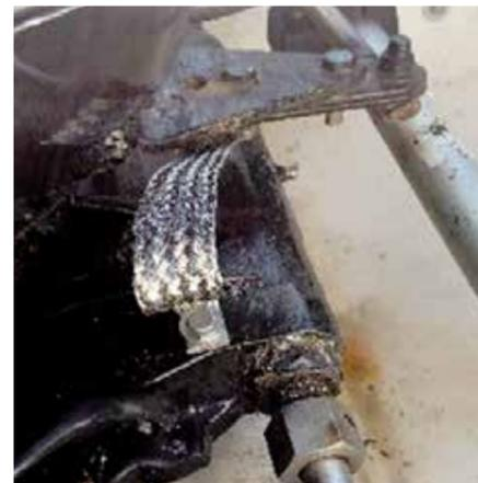
**Le troisième exemple** est un renforcement de la conductibilité entre le bloc moteur et la cosse négative de la batterie par la mise en place d'un conducteur en cuivre, pas en aluminium cuivré mais bien du cuivre à 100%, avec une liaison par une tresse entre ce nouveau conducteur et le fil négatif d'origine sur le moteur au niveau du démarreur.
