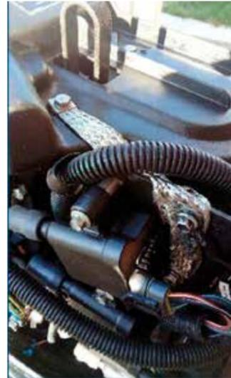
De plus si une bobine ou un fil sur la haute tension n'est pas parfaitement isolé et crée une perte électrique, celle-ci sécoulera par la tresse de masse et sera rapidement détectée par un allumage défectueux sur un cylindre ce qui évite le « coup de chaud » très destructeur des soupapes et tête de piston.
